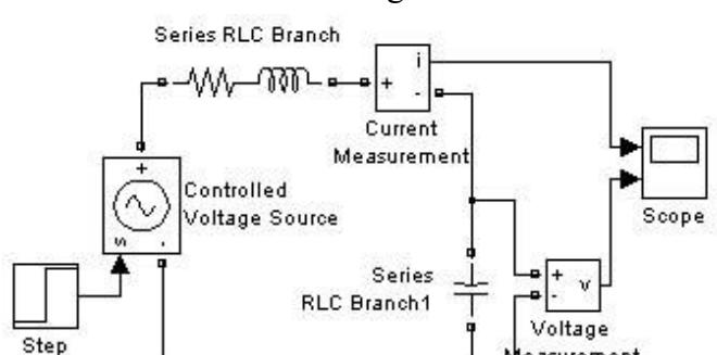
Параметры блоков: Step (Step time – 0.001, Final value - 100); Series RLC Branch (Resistance – 1000, Inductance – 1, Capacitance – inf); Series RLC Branch 1 (Resistance – 0, Inductance – 0, Capacitance – 0.0000001); Scope (Number of axes – 2); все параметры остальных блоков – по умолчанию.
