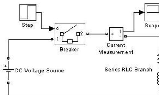
4. Соберите схему, в которой блоки Current Measurement и Voltage Measurement используются для измерения тока и напряжения на конденсаторе последовательного колебательного контура. Simulink-сигналы, формируемые данными блоками, используются затем для отображения тока и напряжения на осциллографе.
